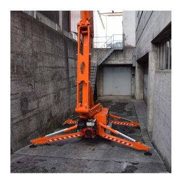
Durch die schmale Abstützbasis von nur 3m x 3m ist die Bühne auch unter beengten Verhältnissen einsetzbar
